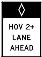
Rysunek 2.6: Znak pasa ruchu dla pojazdów specjalnych W tym przykładzie pas ruchu jest zarezerwowany dla pojazdów przewożących pasażerów (HOV).
