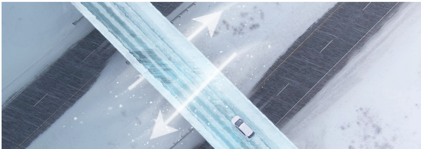
Rysunek 5.9: Lód na mostach tworzy się głównie z powodu cyrkulacji powietrza zarówno nad, jak i pod powierzchnią jezdni.
