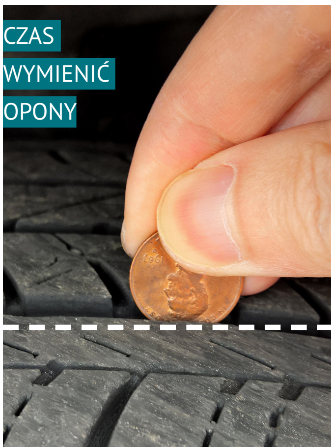
Rysunek 3.1: Sprawdź bieżnik opony za pomocą monety 1 groszowej
