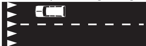
Hình 2.2: Vạch nhường đường
