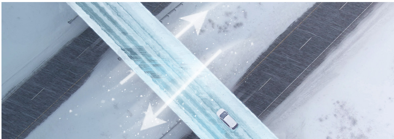
圖 5.9：由於路面上方和下方的空氣循環，結冰會首先在橋樑上形成。
