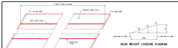
PART PLAN SHOWING LONGITUDINAL UHPC JOINTS BETWEEN BEAMS
