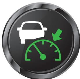
**Descrição:** Pode aumentar ou diminuir a velocidade do veículo para manter a seguinte distância definida pelo condutor. As versões avançadas podem até retardar e parar o veículo em engarrafamentos de trânsito e depois acelerar automaticamente.
