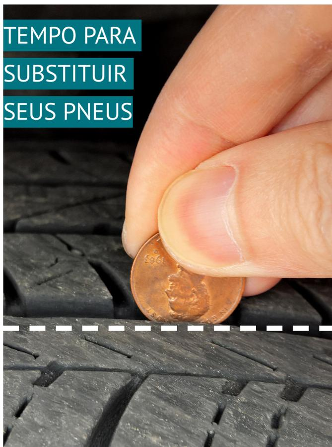
Figura 3.1: Verifique a banda de rodagem de seu pneu com um centavo
