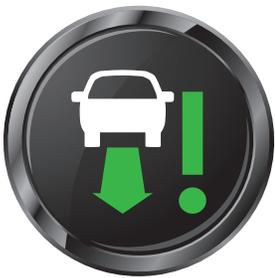
**Beschreibung:** Diese Funktion überwacht den Verkehr, wenn Sie bei niedriger Geschwindigkeit nach links abbiegen (z.B. an einer Ampel). Es aktiviert Warntöne und Armaturenbrettbeleuchtung und bremst automatisch, wenn Sie nach links in den Weg eines anderen Fahrzeugs abbiegen.
