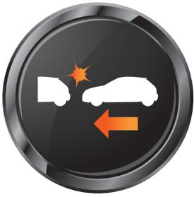
**Beschreibung:** Warnt Sie vor einer drohenden Kollision mit einem langsamer fahrenden oder stehenden Fahrzeug oder Objekt vor Ihnen, damit Sie rechtzeitig bremsen oder ausweichen können. Die Warnung allein wird nicht automatisch für den Fahrer bremsen. Der Kollisionswarner scannt während der Fahrt die Straße vor Ihnen.
