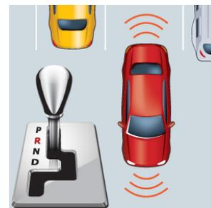
Verlassen Sie sich nicht allein auf die Parksensoren, um alle Objekte zu erkennen. Sie erkennen möglicherweise keine Objekte, die flach auf dem Boden liegen, sich unter der Stoßstange befinden, zu nahe am Fahrzeug oder zu weit davon entfernt sind. Achten Sie beim Einparken mit Hilfe von Spiegeln, Kopfkontrollen und Rückfahrkameras auf Ihre Umgebung und auf Personen oder Gegenstände, die in den Parkweg eindringen könnten.
