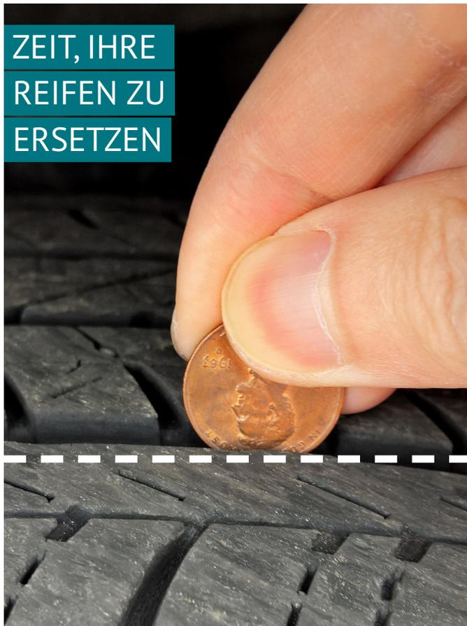
Abbildung 3.1: Prüfen Sie Ihr Reifenprofil mit einem Penny
