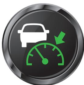
**Descrizione:** Può aumentare o diminuire la velocità del veicolo per mantenere la distanza di inseguimento impostata dal conducente. Le versioni avanzate possono persino rallentare e arrestare il veicolo negli ingorghi e poi accelerare automaticamente.
