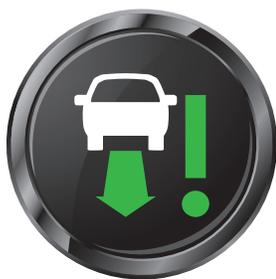
**Descrizione:** Questa funzione monitora il traffico quando svoltate a sinistra nel traffico a bassa velocità (come ad esempio ad un semaforo). Attiva i suoni di avvertimento e le luci del cruscotto e applica automaticamente il freno se state svoltando a sinistra verso un altro veicolo.
