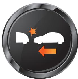
**Descrizione:** Vi avverte di una collisione imminente con un veicolo o un oggetto in movimento o fermo davanti a voi, in modo da permettervi di frenare o sterzare in tempo. L'avviso da solo non frenerà automaticamente per il conducente. L'avviso di collisione in avanti analizza la strada davanti a voi durante la guida.
