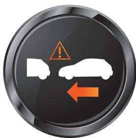
**Descrizione:** Potete applicare i freni se viene rilevato un ostacolo durante la retromarcia del veicolo. Vi aiuta a evitare un possibile incidente quando il veicolo si muove in retromarcia.
